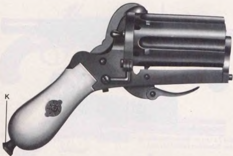
Bild 8: Bündelrevolver für Stiftzündpatronen (Lefauchaux) um 1870/80. Der Knopf K am unteren Griffende gehört zum Ausstoßer, der zum Entfernen der leeren Hülsen aus dem Griff herausgezogen werden muß.
