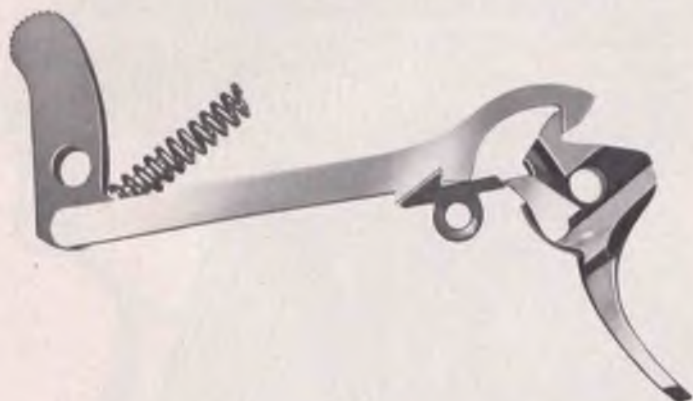
Bild 14: Lage der Schloßteile in der Ruhelage, der Abzug beginnt die Spannstange zu bewegen.
