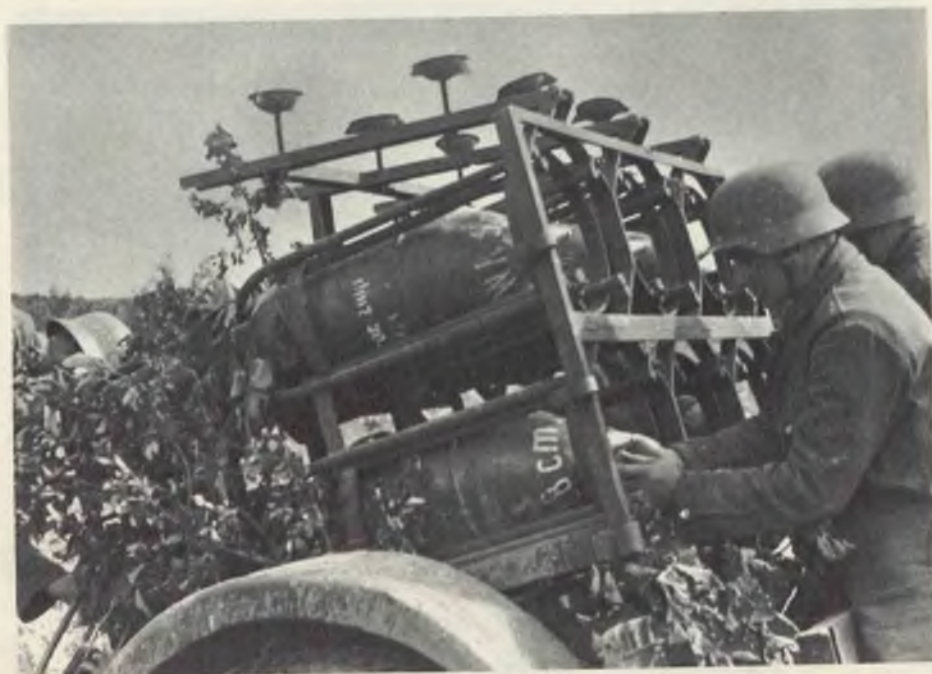
Bild 9: K 3 und K 4 setzen Zündladungen und Zünder ein
