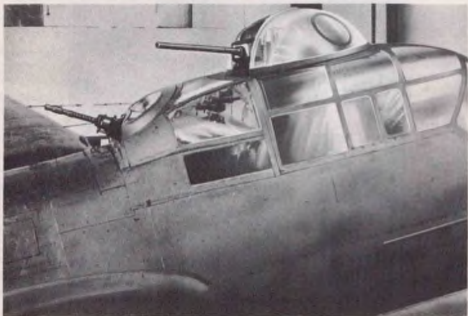
Bild B: Ju 188 A-2 mit MG 151/20 in kraftgesteuertem Drehturm (rechts) und MG 131 (links)
