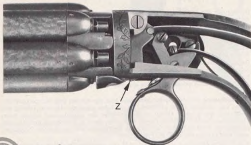
Bild 21: Abzug voll durchgezogen, Hammer abgefallen. Z = Kupplungszahn am Hammer.
