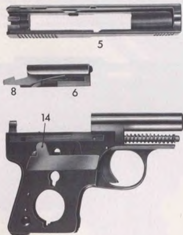
Bild 8: Verschlussstück und -hülse abgenommen: 5 = Verschlusshülse, 6 = Verschlussstück, 8 = Verschlussstückhalter, 14 = Abzugstange mit Winkelhebel.
