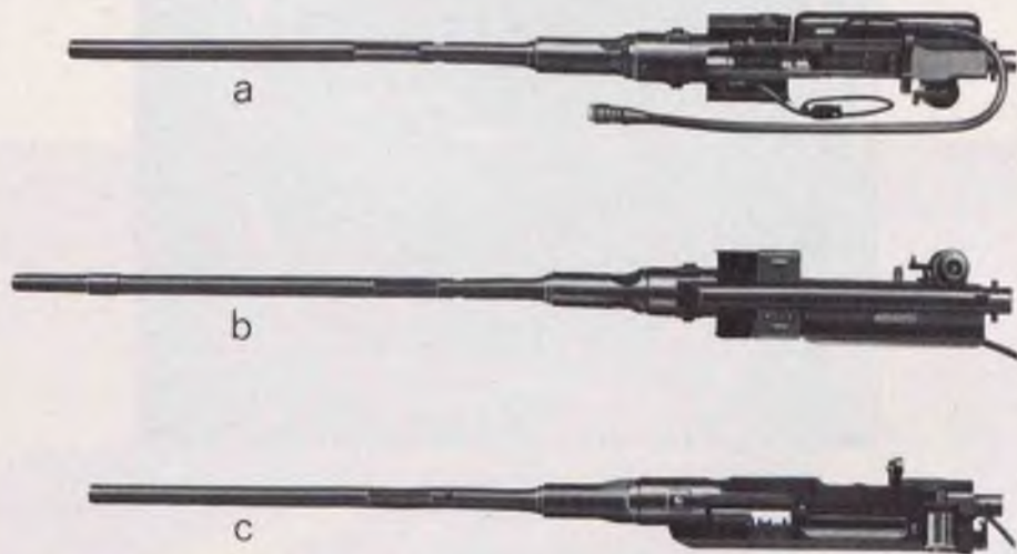
Bild 1: a = MG 151/20 für elektrische Zündung von unten, b = MG 151 von oben, c = MG 151 von rechts
