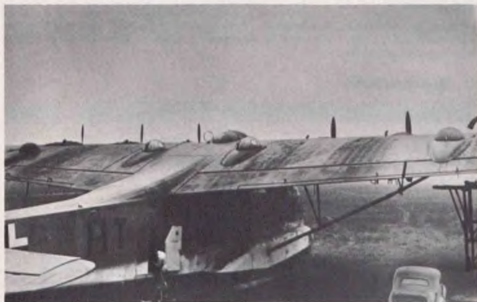
Bild D: „Flakkreuzer“ Me 323 E-2/WT mit 4 MG 151 in EDL 151-Waffentürmen auf dem Flügel
