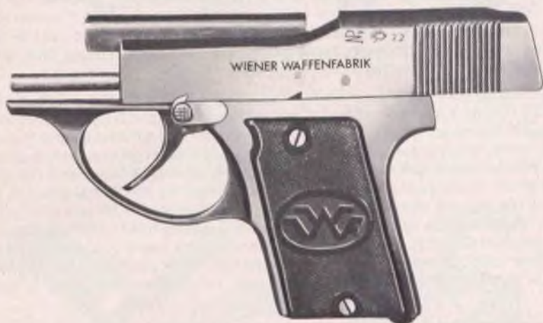
Bild 20: Schlitten gerastet, der Lauf ist zur Demontage nach hinten geschoben.
