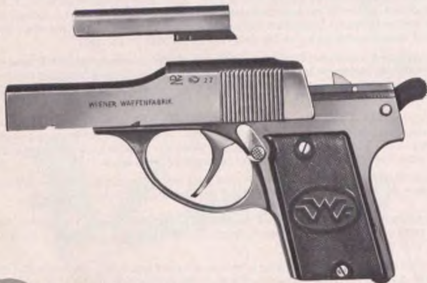
Bild 21: Der Lauf ist nach oben abgenommen, der Schlitten entriegelt und nach vorne geglitten.
