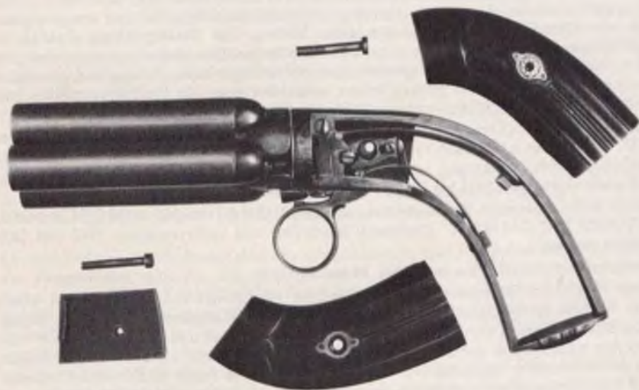
Bild 16: Mariette-Bündelrevolver geöffnet, Griffschalen abgenommen.
