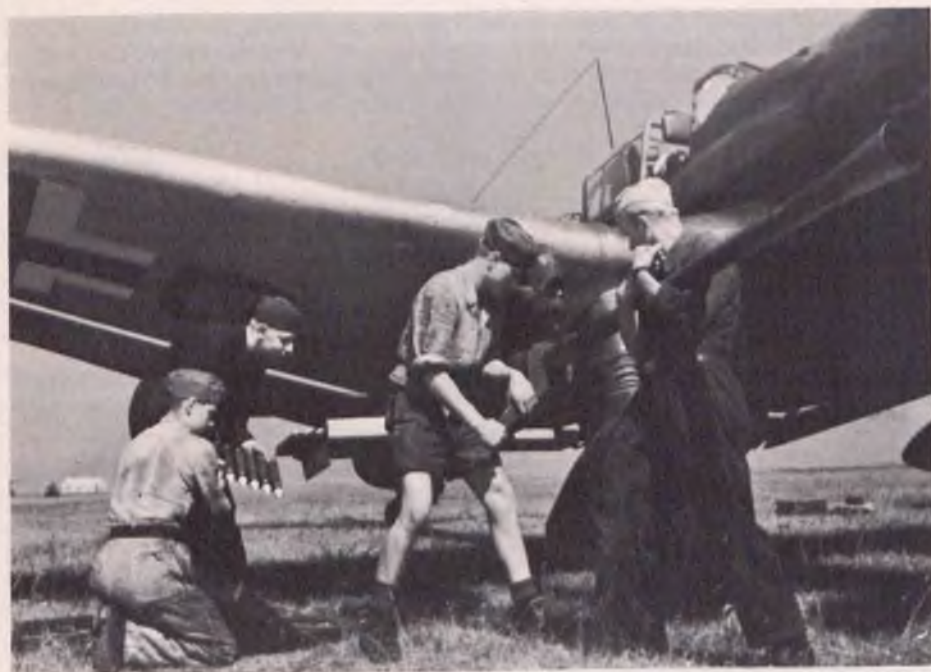
Bild 7: Das Rohr wird festgeschraubt und die Patronenrahmen werden eingeführt
