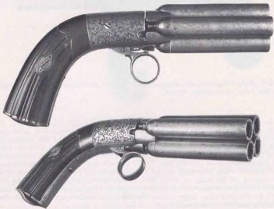
Bild 1 und 2: Vierläufiger Mariette-Bündelrevolver mit Ringabzug; abschraubbare Damastläufe, Schloßkasten graviert, Griffschalen aus Ebenholz. Kaliber 12 mm; Gesamtlänge 220 mm; Gewicht 0,66 kg
