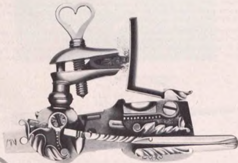
Bild 3: Zünden eines Steinschlusses
