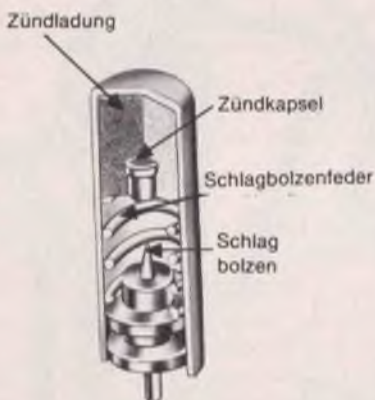
Bild 3: Bodenzünder im Schnitt
