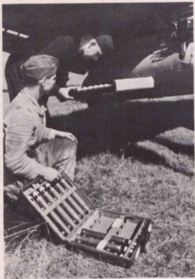
Bild 8: Einführen der Patronenrahmen
