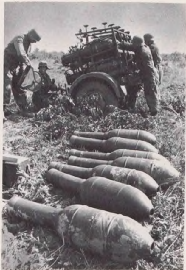
Bild 10: Während die Zünder eingeschraubt werden, wird das Zündkabel ausgelegt, wobei der Werferführer zunächst die Steckerbuchse festhält.
