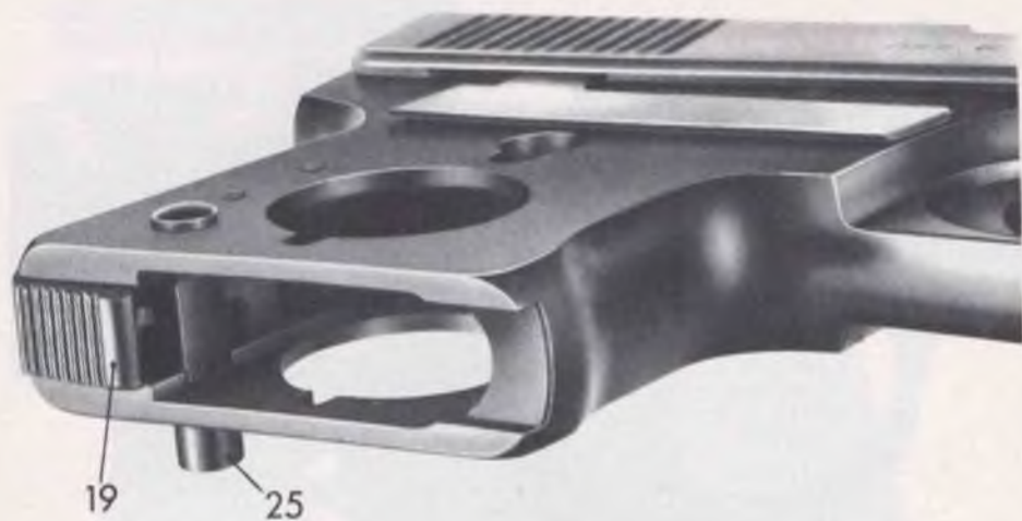
Bild 10: Griffschalen entfernt: 19 = Magazinhalter, 25 = Griffschalenhaltebolzen.
