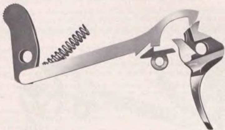
Bild 16: Der Hammer ist abgeschlagen, der Abzug noch gezogen, die Spannstange legt sich auf den Fanghaken.
