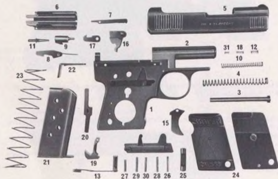
Bild 15: Einzelteile: 1 = Gehäuse, 2 = Lauf, 3 = Führungsstange, 4 = Schließfeder, 5 = Verschlusshülse, 6 = Verschlussstück, 7 = Auszieher, 8 = Verschlussstückhalter, 9 = Schlagbolzen, 10 = Schlagbolzenfeder, 11 = Signalstift, 12 = Signalstiftfeder, 13 = Sicherung, 14 = Abzugstange mit Feder, Hebel und 2 Stiften (genietet), 15 = Abzug, 16 = Abzughebel, 17 = Fanghaken, 18 = Fanghakenfeder, 19 = Magazinhalter, 20 = Magazinhalterfeder, 21 = Magazin, 22 = Zubringer, 23 = Zubringerfeder, 24 = Griffschalenpaar, 25 = Griffschalenhaltebolzen, 26 = Stift für Abzug, 27 = Stift für Führungsstange, 28 = Stift für Abzug, 29 = Stift für Magazinhalterfeder, 30 = Stift für Auszieher, 31 = Feder für Auszieher.
