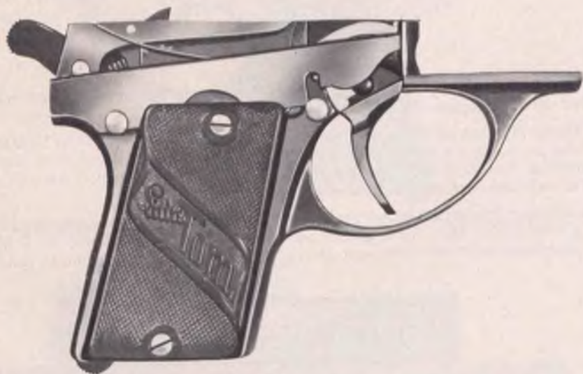
Bild 24: Die Abdeckplatte für den Schloßmechanismus kann nach oben aus Ihrer Halterung geschoben werden.
