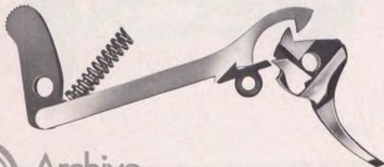
Bild 19: Der abgeschlagene Hammer wurde in die Ruhrast gelegt, der Abzug ist frei.
