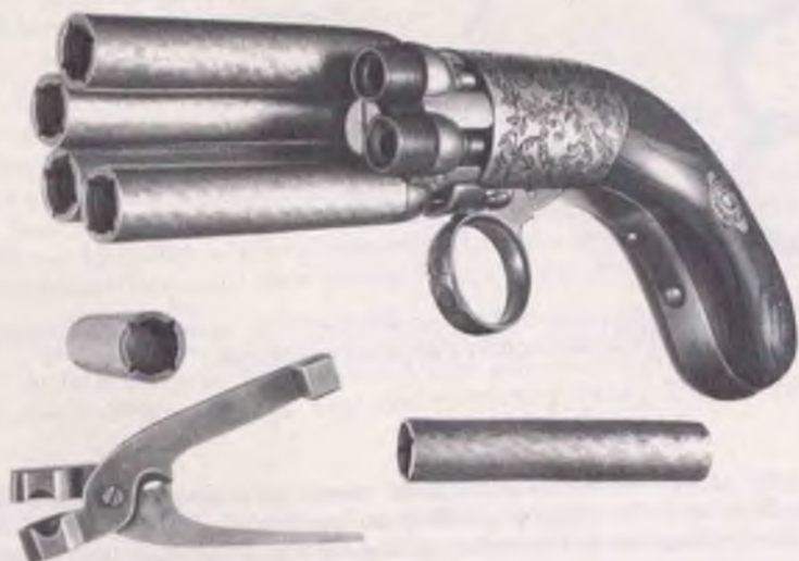
Bild 11: Mariette-Bündelrevolver mit zwei abgeschraubten Läufen, der Vierkant am Schenkel der Kugelzange dient als Schlüssel und wird in die Mündungen gesteckt.
