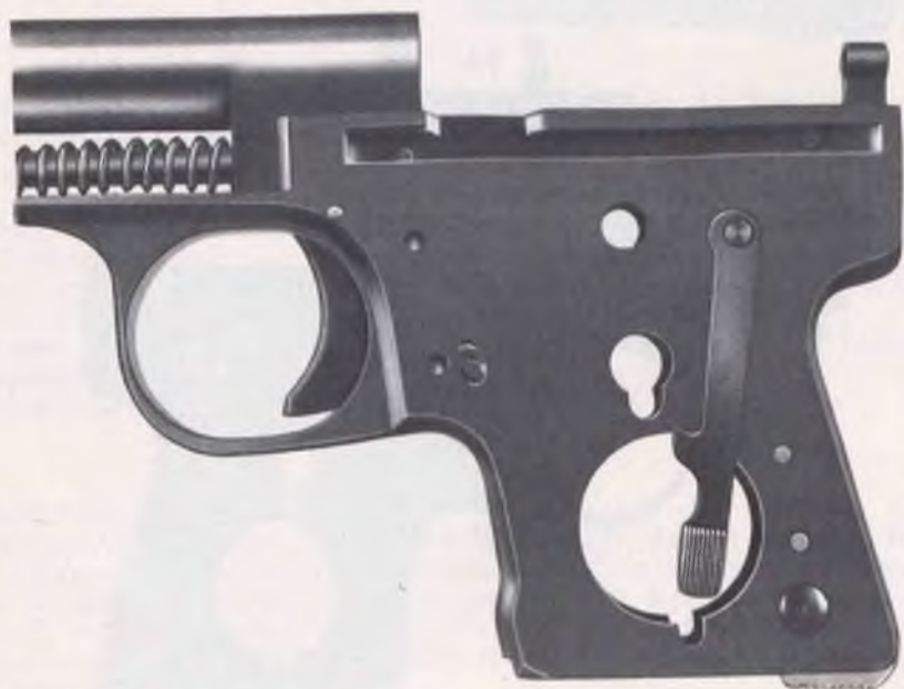
Bild 11: Ausbau der Sicherung.
