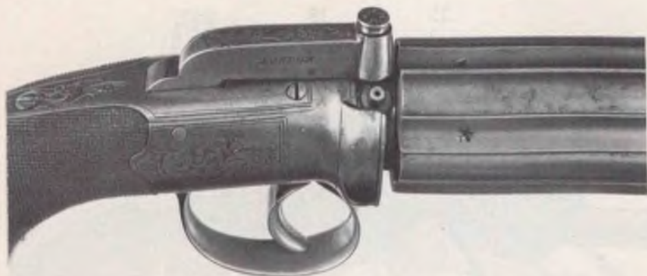
Bild 32: Schutzring für die Zündkegel mit Freiarbeitung zum Aufsetzen der Zündhütchen. Laufbündel in Zwischenstellung gerastet.
