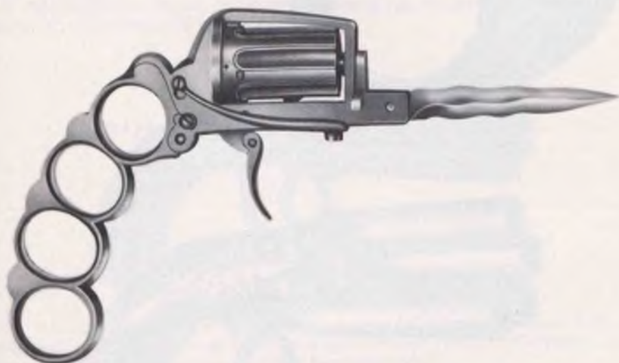
Bild 9 a und b: Zwei sogenannte Apachen-Revolver für Levauchaux-Patronen, Dolch und Schlagringgriffstück können meistens angeklappt werden.
