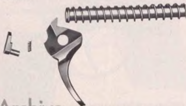
Bild 25: Abzug mit Schließfeder und Druckbolzen, Abzugsklinke und Feder.
