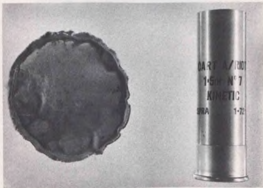
Bild 4: Die Kinetic-Patrone Nr. 7. Rechts die ladefertige Patrone, links das Leinensäckchen mit den Bleikugeln.
