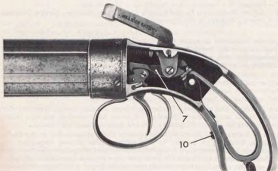
Bild 26: Hammer kurz vor dem Niederfallen, die Kupplung 7 gleitet vom Abzug ab, die Spanschraube 10 ist nur zur Entspannung der Schlagfeder zurückgedreht.
