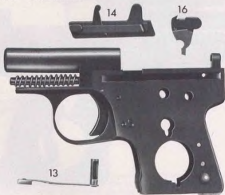
Bild 13: Sicherung, Abzugstange und -hebel ausgebaut: 13 = Sicherung, 14 = Abzugstange, 16 = Abzugshebel, 17 = Fanghaken.
