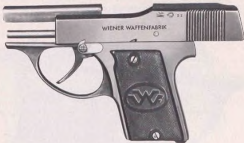
Bild 8: Verschluss geöffnet und vom Sicherungshebel arretiert, nur in dieser Stellung des Schlittens kann das Magazin entnommen werden.
