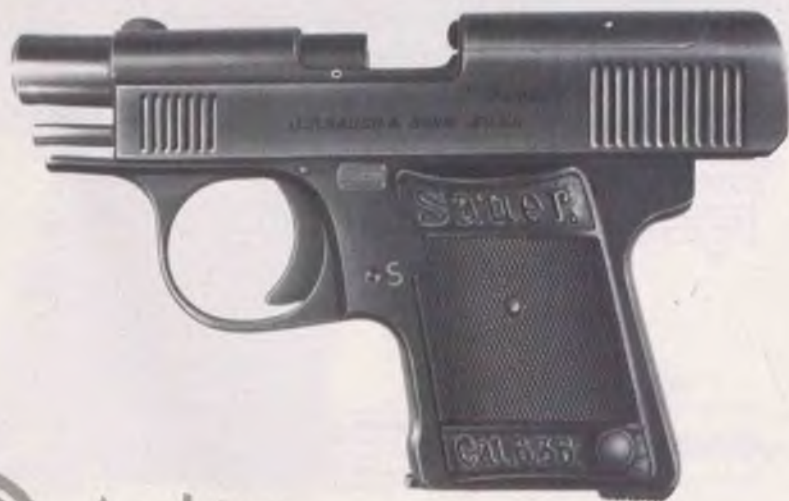
Bild 6: Schlitten zur Demontage des Verschlußstückes mittels Sicherungshebel festgelegt.
