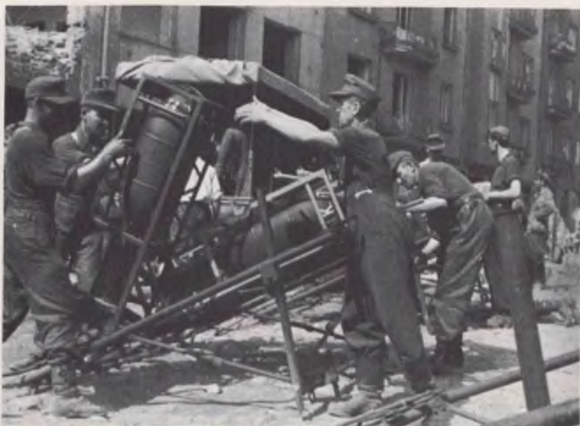
Bild 3: Die Wurfkörper werden mitsamt den Packkisten aus Stahl auf den Wurfrahmen aufgesetzt
