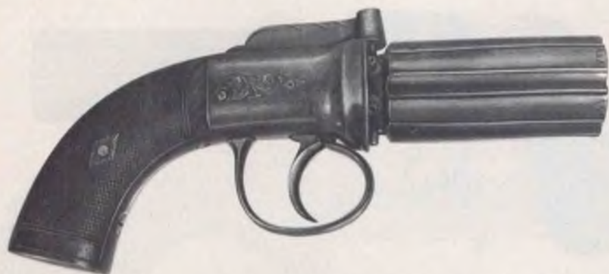
Bild 14: Englische sechsläufige Pepperbox ohne Sign. einfache Ausführung, Griffschalen aus Nußbaumholz mit Fischhaut, Birmingham - Beschußzeichen. Kaliber .32, Gesamtlänge 208 mm, Gewicht 0,76 kg.
