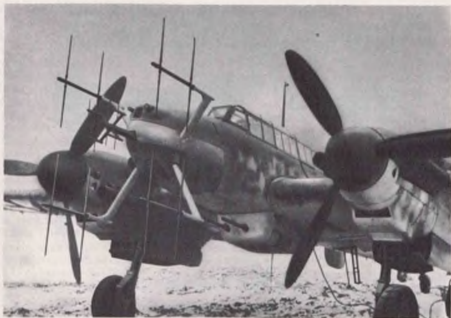
Bild E: Me 110 G-4/R3 mit 2 MG 151/20 und 2 x 30 mm MK 108 im Rumpfbug, 2 MG 151 unter dem Rumpf anstelle des ETC 500, sowie SN 2 Radargerät „Lichtenstein“
