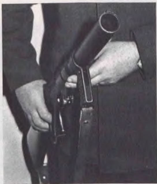
Bild 9: Blick auf den glatten Lauf des Gewehrs.
