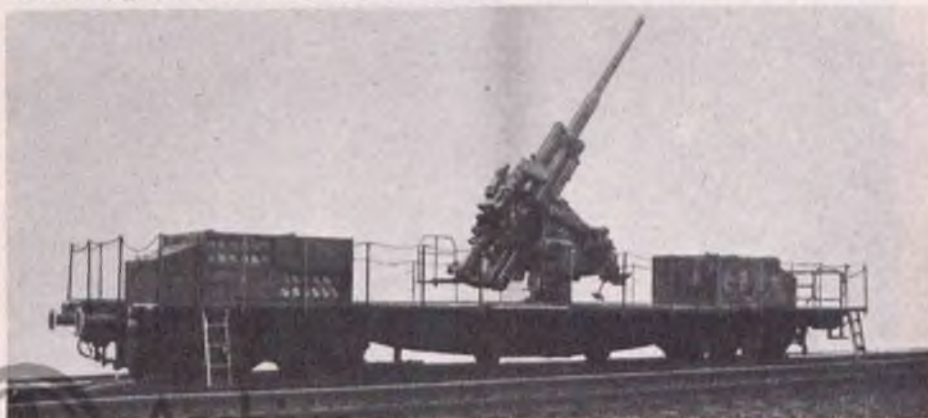
Bild 19: Geschützwagen IV (Eisb.) mit 12,8-cm-Flak in Feuerstellung
