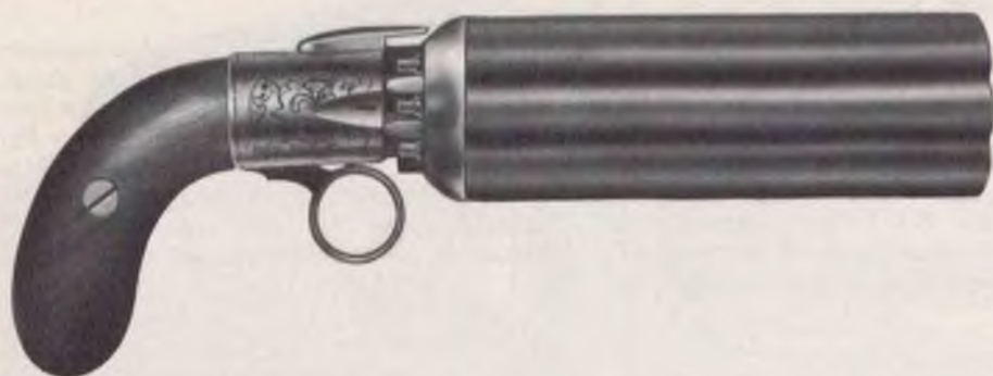
Bild 35: Bündelrevolver von Lhoist, acht Läufe, Ringabzug, innenliegender Hammer der den oberen Lauf zündet. Gesamtlänge 255 mm, Gewicht 1,02 kg.
