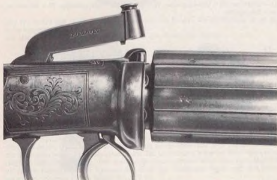
Bild 32 a: Am Hammer ist unten eine viereckige Nase angefeilt, die in die Nuten am Zahnkranz eingelegt werden kann und das Laufbündel in der Sicherheitsstellung rastet.
