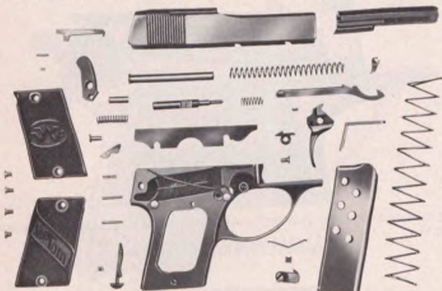
Bild 28: Sämtliche Einzelteile der Little Tom Kaliber 6,35 mm.
