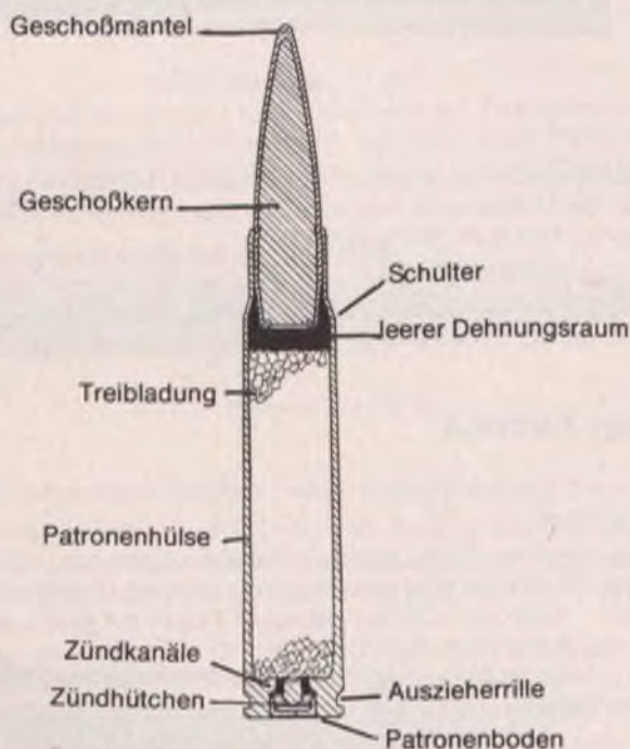
Bild 16: Aufbau einer Militärpatrone
