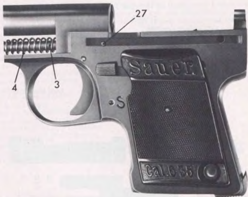
Bild 14: Befestigung der Führungsstange: 3 = Führungsstange, 4 = Schließfeder, 27 = Stift für Führungsstange.
