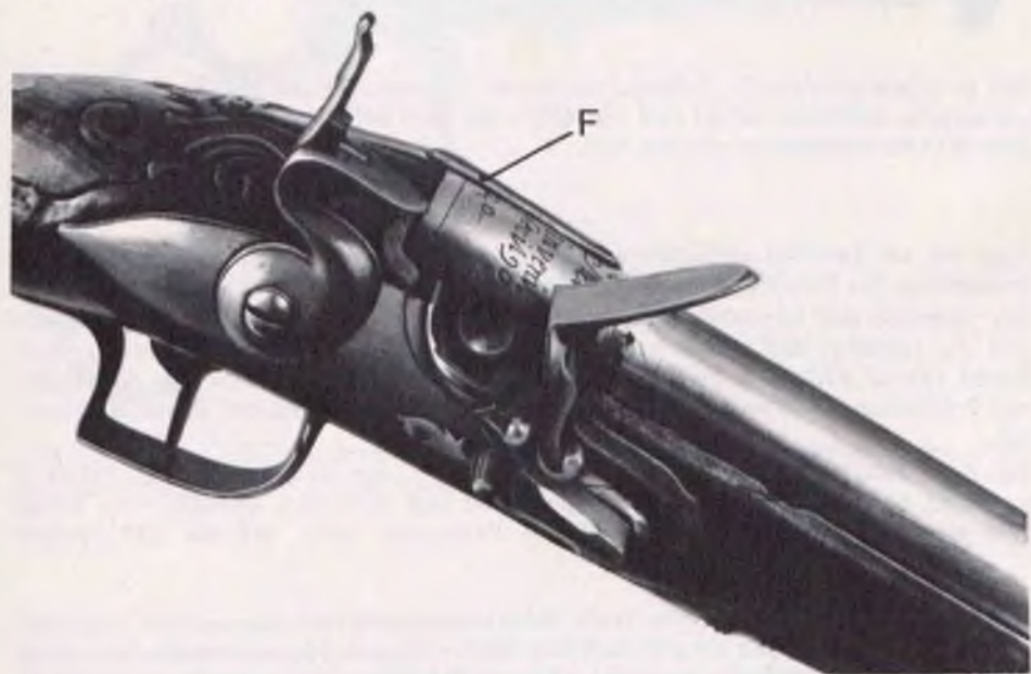
Bild 7 a und b: Steinschloßdrehling sign. „Joseph Michl in Passau 1790“. Bronzelauf mit drei Bohrungen Kaliber 12 mm.
