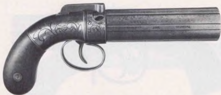
Bild 12: Amerikanische sechsläufige Pepperbox von Allen & Thurber nach Patent von 1837. Oberliegender Hammer, im Schutzring Öffnung zum Aufsetzen der Zündhütchen. Kaliber .31, Gesamtlänge 225 mm, Gewicht 0,80 kg.
