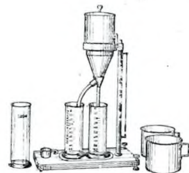
Abb. 10. Apparat zur Bestimmung der Faserlänge nach Schopper-Riegler
