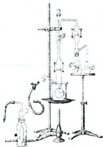
Abb. 4. Apparat zur Bestimmung des Glycerins nach dem Isopropyljodidverfahren
