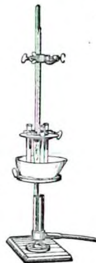
Abb. 28. Apparat zur Bestimmung der Verpuffungstemperatur
