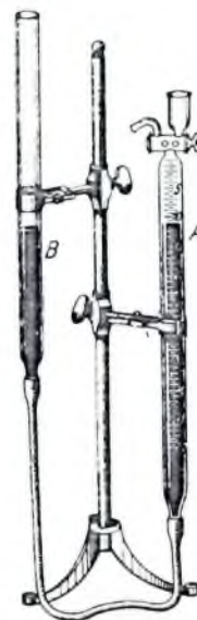
Abb. 13 Nitrometer von Lunge
